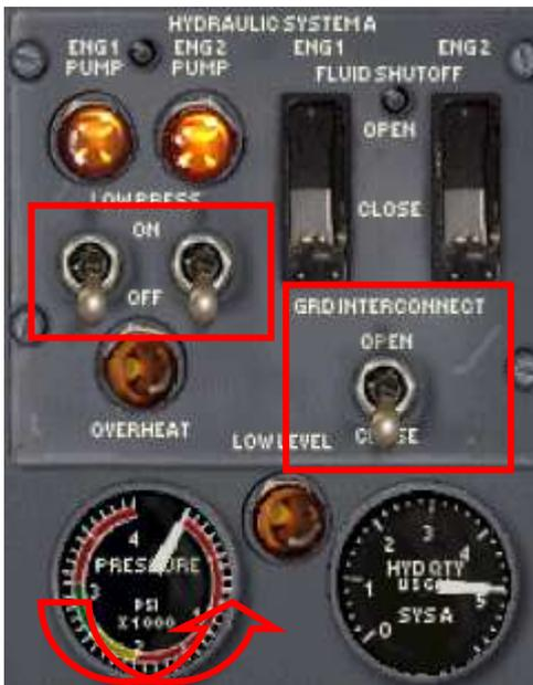
Dès qu'on a fermé l'interconnexion, la pression chute à zéro.
