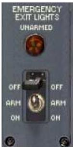
Petit « truc » : inutile d'ouvrir le capot pour savoir car si l'interrupteur n'est pas sur la position « armed », le voyant orange est allumé. L'ensemble doit donc se présenter comme ceci quand tout est OK.
