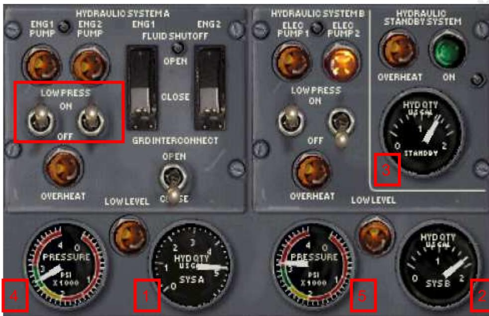
A part les deux interrupteurs entourés en rouge, le reste ne bouge pas. Vérifiez que les quantités et les pressions sont dans les limites :
