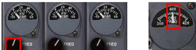
A l'aide du bouton il faut ajuster la fréquence à 400 Hz. Dès que la fréquence est ajustée, les deux témoins cessent de clignoter. Il faut procéder clic par clic pour caler parfaitement la fréquence.
