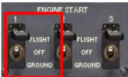
On bascule sur OFF et on ferme le capot de protection
