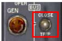
Dès qu'on passé l'interrupteur sur CLOSE, l'APU est déconnectée, ce qui se signale par une FAILURE.
